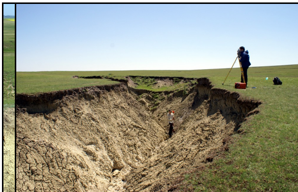
Fig. 4. Echipamentul Stației totale Leica TC 407 folosit pentru ridicarea topografică a Ravenei Gurguiata Mică (2 – 6 iunie 2008).
